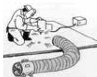
溶接のヒューム排気
